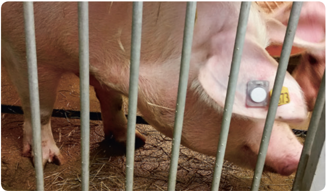
Funktionsmuster der elektronischen Ohrmarke im Einsatz
